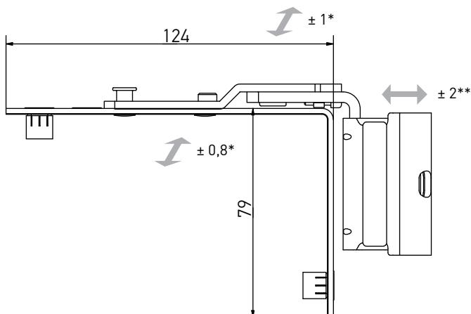
\* Регулировка прижима, мм
