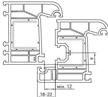
Межфальцевый зазор (A): мин. 12 мм
