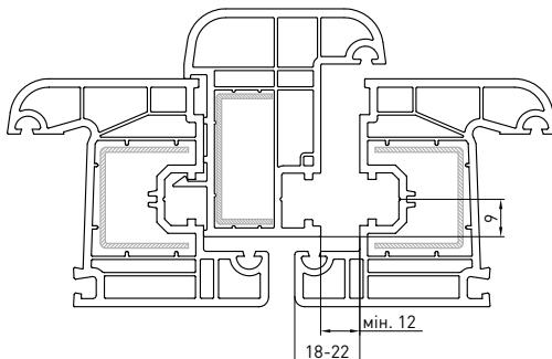
Межфальцевый зазор (A): мин. 12 мм
