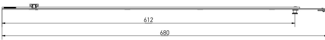
Линейный удлинитель L=880 мм, 2 MR, с приподнимателем створки
