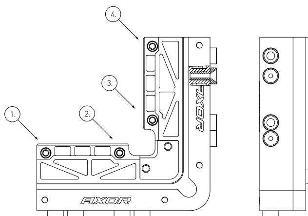
1-4. Регулировочные винты предназначены для фиксации шаблона в фурнитурном пазе створки.
