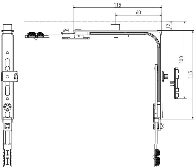
Угловая передача для ступенчатого проветривания, 1 MR, 115x115
