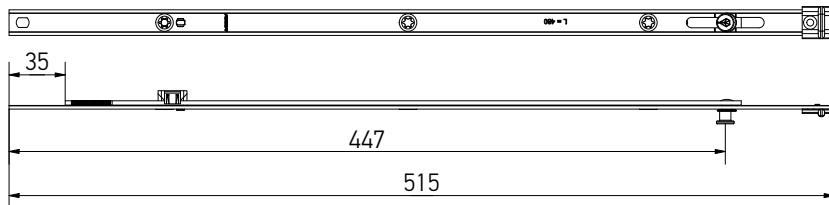
Линейный удлинитель L=680 мм, 1 MR, с приподнимателем створки
