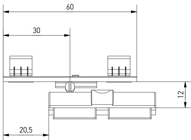
Независимый приподниматель створки A7236-00-N03 используется вместе с рамной частью A7237-XX-N03.
