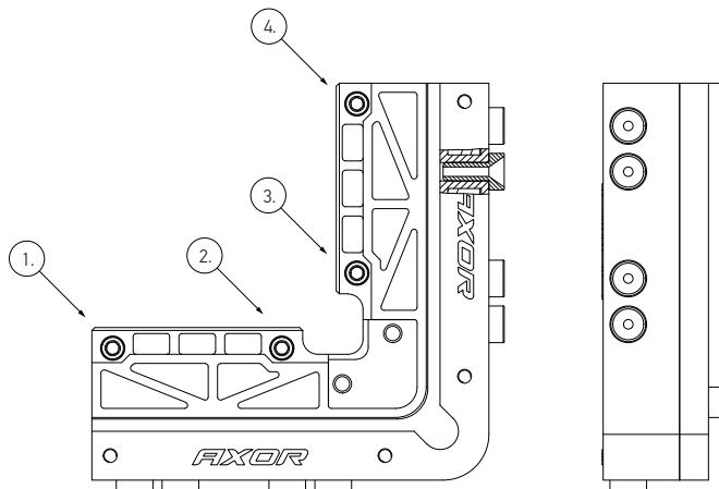
1-4. Регулировочные винты предназначены для фиксации шаблона в фурнитурном пазе створки.
